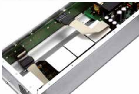
Wärmeleitblech, gefertigt aus Aluminium
