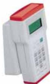
Для L-версии корпуса, имеющей форму пульта, настенный монтаж возможен путём поворота нижней части.
