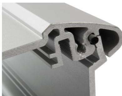
Для достижения класса защиты IP 54 следует, наряду с имеющимся в дополнительной оснастке уплотнением AT...DI, также смонтировать на заводе-изготовителе уплотнение круглого сечения в профиль корпуса.
